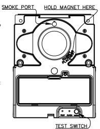
FIGURE 8. DH-100-P TEST LOCATIONS
